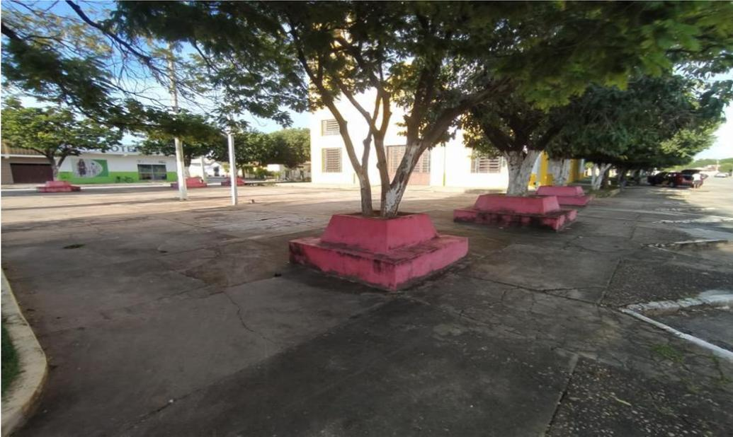
FOTO 14 - PRAÇA SANTANA: DEMOLIR CANTEIROS/DEMOLIR PISO/REBAIXAR PISO/PAVIMENTAR COM BLOCOS INTERTRAVADOS RETANGULARES COLORIDOS.
