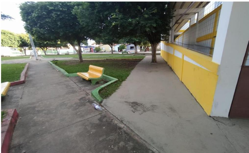
FOTO 12 - PRAÇA SANTANA: DEMOLIR CANTEIROS/DEMOLIR PISO/REBAIXAR PISO/PAVIMENTAR COM BLOCOS INTERTRAVADOS RETANGULARES COLORIDOS.
