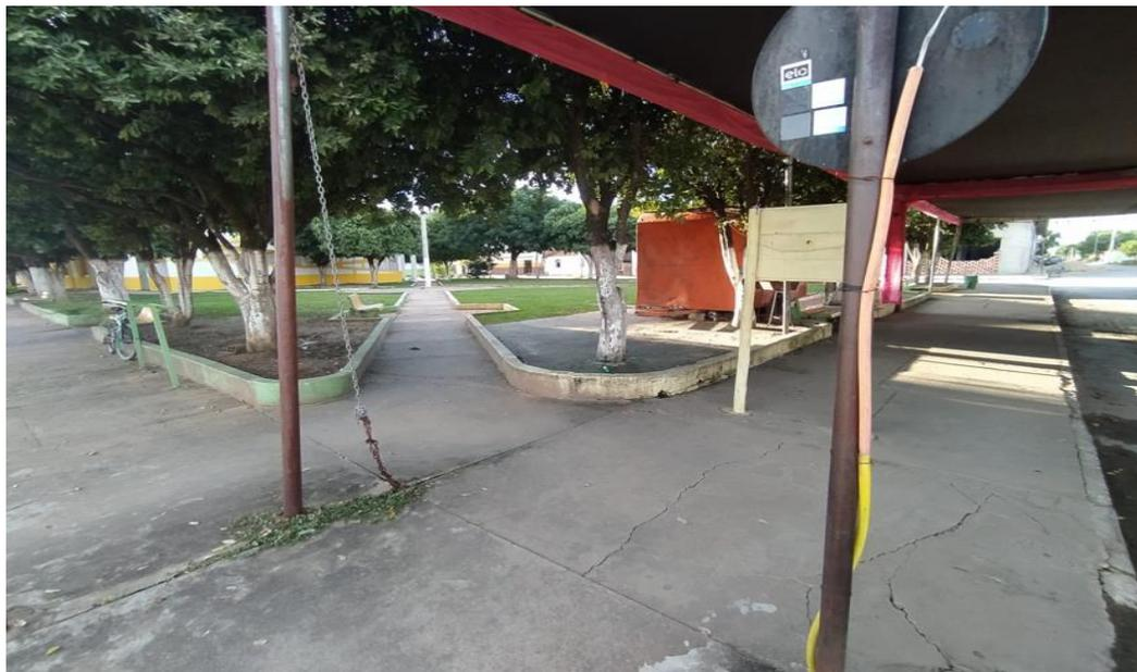
FOTO 08 - PRAÇA SANTANA: DEMOLIR CANTEIROS/DEMOLIR PISO/REBAIXAR PISO/PAVIMENTAR COM BLOCOS INTERTRAVADOS RETANGULARES COLORIDOS.
